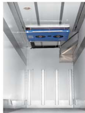
Längsgeteilt mit Stirnwandmaschine für TK-Bereich und RE-Verdampfer für FD-Zone.
