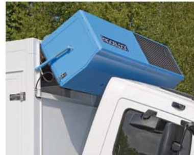
Aufklappmechanik für geringere Aufbauhöhe
