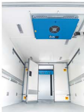
Quergeteilt mit EK-Unterflur und zwei RE-Verdampfern für TK- und FD-Bereich.
